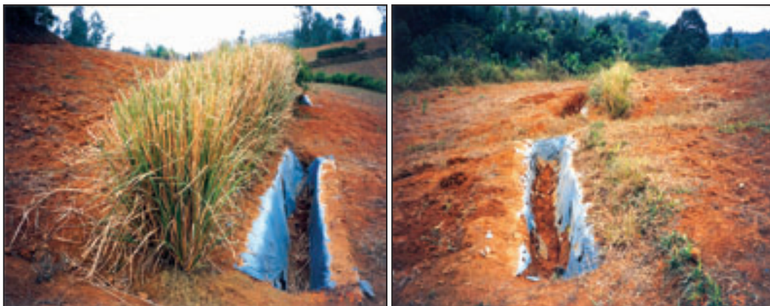
Foto 4: Diferença de perda de solo entre vetiver (esquerda) e Flemingia congesta (direita), uma leguminosa.
